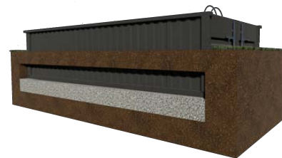
Teilweise im Erdreich versenkt inkl. Verstärkung
